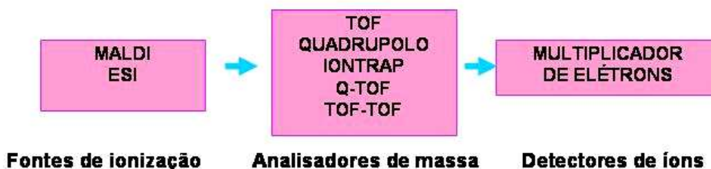
Figura 1. Componentes básicos de um espectrômetro de massa.
