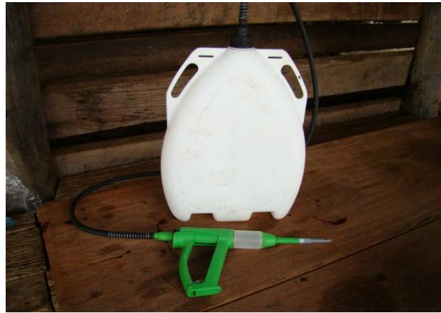
Figura 4 - Seringa dosadora, com capacidade de 30ml, acoplada à recipiente contendo água filtrada. Ponteira plástica de micropipeta, descartável (individual).
