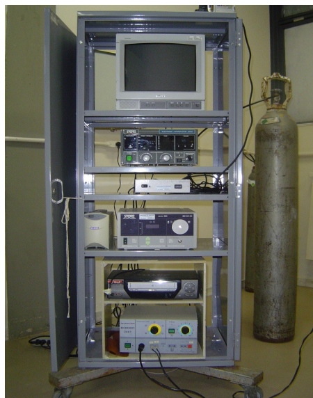
Figura 4. Equipamento para vídeo-cirurgia. Monitor 14 polegadas, insuflador eletrônico, microcâmera, fonte de luz de xenônio com cabo de fibra ótica, cilindro de CO 2 . Foto: Escola de Veterinária da UFMG.
