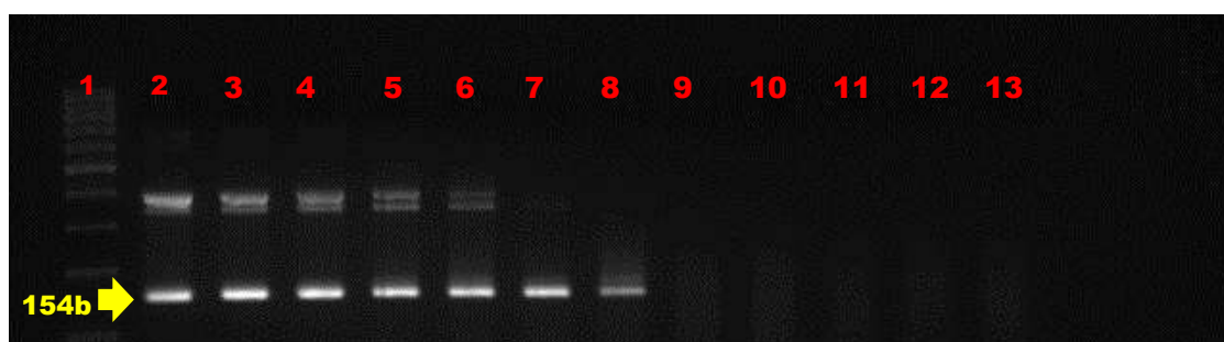
Figura 6: Avaliação da sensibilidade da PCR Semi Nested (PCR-SN) na detecção do gene pol do BIV, realizada através do clone MG79. Canaleta 1: Padrão de tamanho molecular de 100 pb. Canaleta 2: Clone MG079 puro. Canaletas 3-12: Diluições crescentes do clone correspondentes a 10^{-4} ; 10^{-5} ; 10^{-6} ; 10^{-7} ; 10^{-8} ; 10^{-9} ; 10^{-10} ; 10^{-11} ; 10^{-12} e 10^{-13} . Canaleta 13: Controle negativo.
