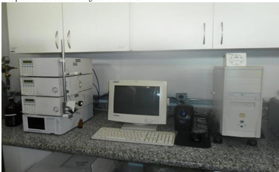
Figura 4: Cromatógrafo utilizado para determinação do índice de CMP (mg/L) em amostras de leite pasteurizado das mesorregiões de Minas Gerais.
