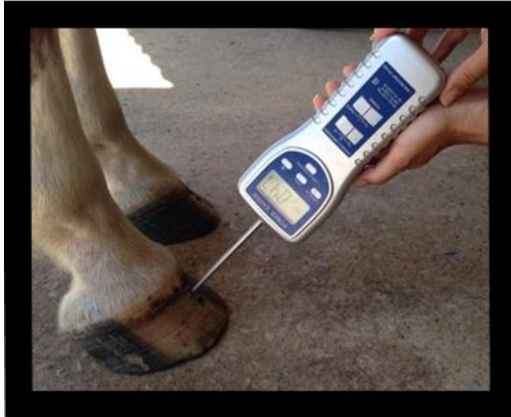
Figura 1 – Utilização do dinamômetro de compressão portátil (Instrutemp 20kgf ITFG-5020, São Paulo/Brasil) na avaliação do limiar nociceptivo mecânico da região laminar dorsal.
