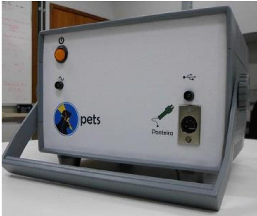
**Figura 4.** Aparelho eletroporador desenvolvido pelo Departamento de Engenharia Elétrica da Escola de Engenharia da UFMG para uso na técnica da eletroquimioterapia *in vivo*.
