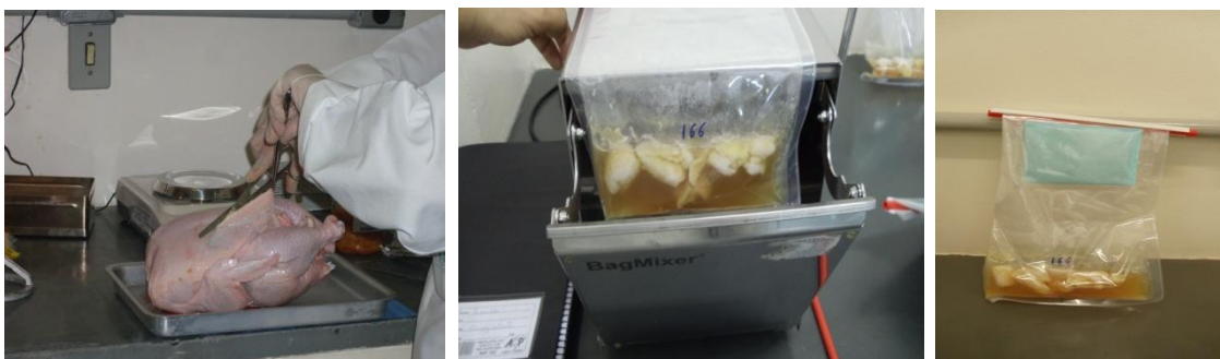
Figura 4. Pesagem da amostra, homogeneização e a amostra dentro do saco Combibag com o gerador de microaerofilia e barra de vedação
