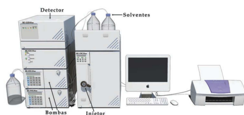
Figura 2 - Diagrama ilustrativo das principais partes de um cromatógrafo moderno
