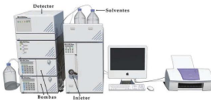
Figura 6. Diagrama esquemático de um sistema de cromatografia líquida de alta eficiência. Fonte: Lanças (2009).
