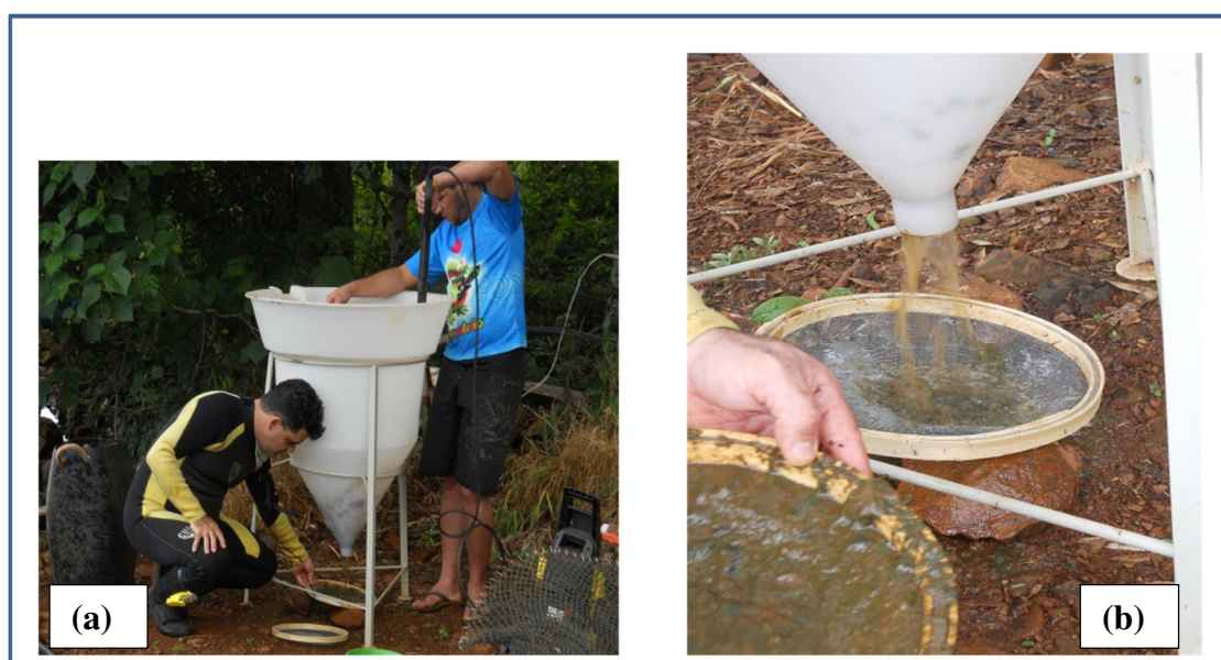
FIGURA 15 - (a) Lavagem das telas com jato de água para retirada da colmatação; (b) coleta do substrato (colmatação) retirado das amostras de tela. FONTE: Arquivo pessoal.
