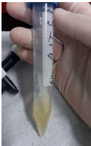
Figura 7. Amostra extraída com ácido tricloroacético 5% demonstrando a turbidez da amostra
