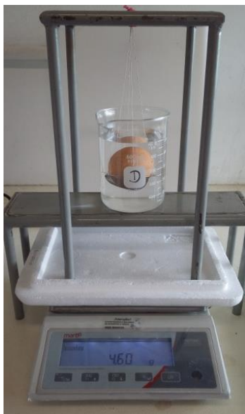
Figura 2: Equipamento para avaliação do peso específico.
