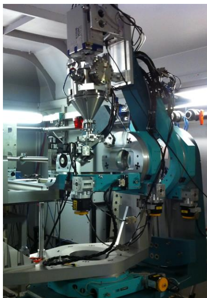
Figura 4.6 - Difratômetro de raios X da linha XDS do LNLS utilizado para realização do experimento GID.
