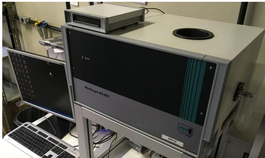
**Figura 3.11:** Espectrômetro de EPR da empresa Magnettech.
