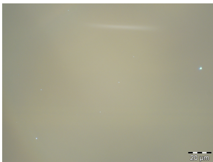
Figura 2.3: Imagem de microscopia de campo escuro, de um substrato, após o método de limpeza.
