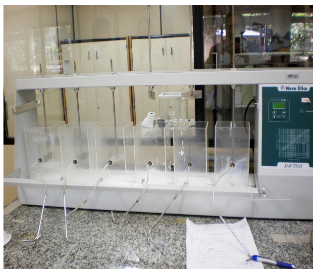
Fig. 25: Aparelho de teste de jarros utilizado para a dosagem dos coagulantes.
