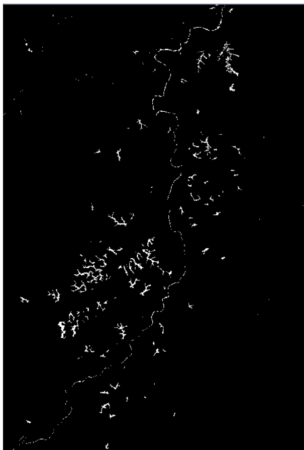
Figura 4 – Resultado de classificação supervisionada de áreas referentes a água aberta em imagem Landsat (15/07/1989) no sistema lacustre do Vale do Rio Doce em Minas Gerais, através do software E.R.Mapper 7.0.
