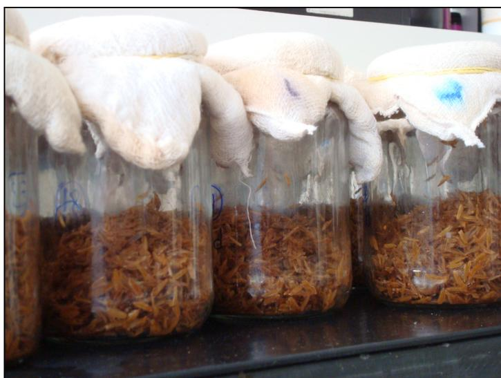
**Figura 8** – Frascos contendo o meio para FSS, após a esterilização.
