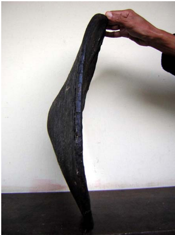
Fig. 4 – Fotos de uma bateia usada para apuração do ouro. Devido a sua técnica simples e eficaz, teve larga difusão nas Minas setecentistas e pode ser encontrada até hoje entre garimpeiros. Acervo pessoal. Museu da Passagem, Mariana. maio, 2006.
