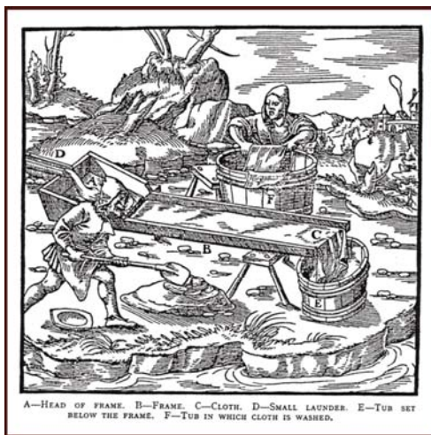
Fig. 28 – Caixa de madeira para a lavagem de sedimento aurífero adotada nas explorações europeias do século XVI. Georgius Agricola, 1556.
