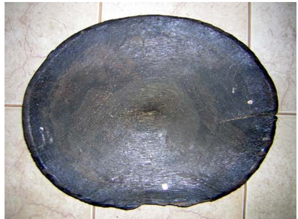
Fig. 4 – Fotos de uma bateia usada para apuração do ouro. Devido a sua técnica simples e eficaz, teve larga difusão nas Minas setecentistas e pode ser encontrada até hoje entre garimpeiros. Acervo pessoal. Museu da Passagem, Mariana. maio, 2006.
