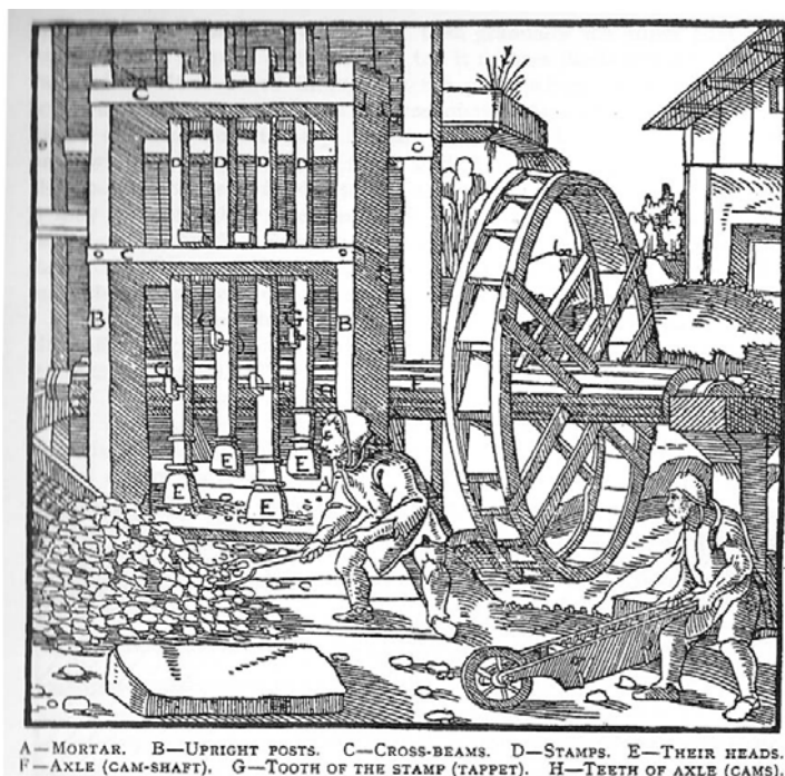
Fig. 36 – Engenho de pilões de socar pedra empregado nas explorações européias. Georgius Agricola, 1556.
