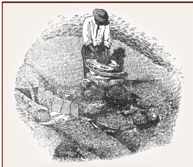
Fig. 23 – Negro triturando o minério aurífero com o auxílio de grandes blocos de pedra. O pó assim obtido era em seguida apurado na canoa (lado esquerdo) ou na bateia.
