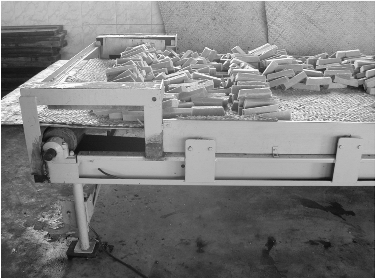
FIGURA 13 - Esteira mecânica para rapadura. Criação do senhor João Leite no Engenho Dois Irmãos, em Barbalha, CE.
