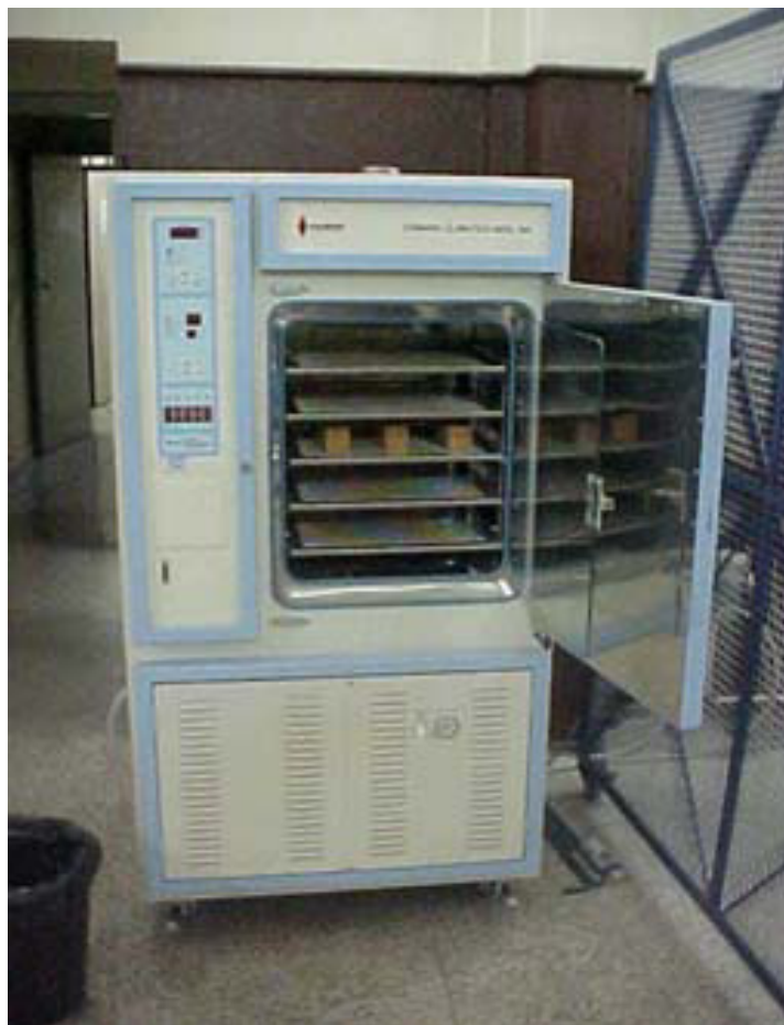
FIGURA 49 - Câmara de climatização aberta para colocação dos corpos-de-prova
