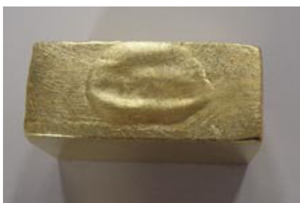
FIGURA 41 - Detalhe do corpo-de-prova dourado (pertencente ao grupo de amostra número 8) com bolha.
