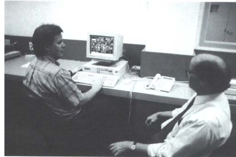
FIG. 25 - As novas instalações têm um sofisticado sistema de monitoramento para verificar a qualidade do ar e determinar a presença de alguma substância prejudicial para as películas. É apresentado aqui o terminal conectado com o sistema cujo controle se dá por computador.
