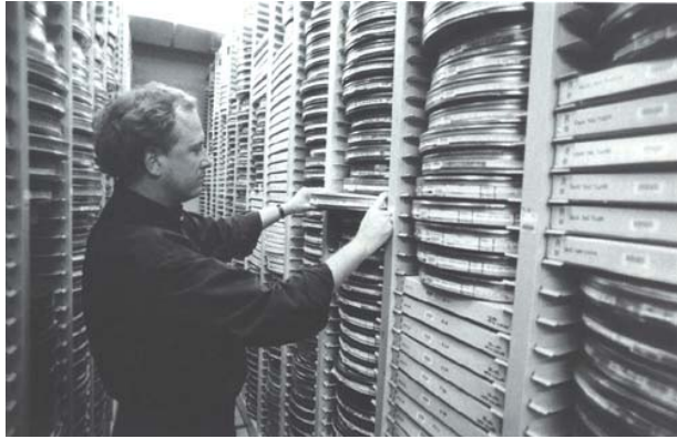
FIG. 21 - Arquivos especialmente projetados, para colocar o rolo de filme em divisões separadas, simplificando a localização de um rolo específico. A Paramount inaugurou um programa especial de troca das latas de filmes, colocando latas alcalinas isoladas de papelão com o intuito de prevenir a acumulação gradual de vapor de ácido acético, ocorrida nas latas normais. O ar dessa instalação é filtrado para remover esses vapores. McCracken é mostrado aqui puxando uma lata contendo um rolo de um negativo original do filme O poderoso chefão – Parte II , Francis Ford Coppola ( The Godfather – Part II , 1974).
