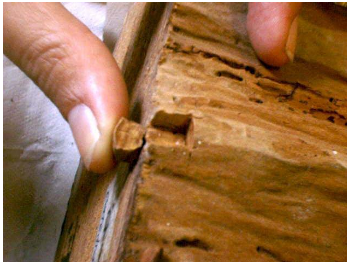
FIGURA 105 —Coleta das amostras do suporte da escultura CB 034. Notar as cavidades no verso da escultura, resultantes do severo ataque de xilófagos.
