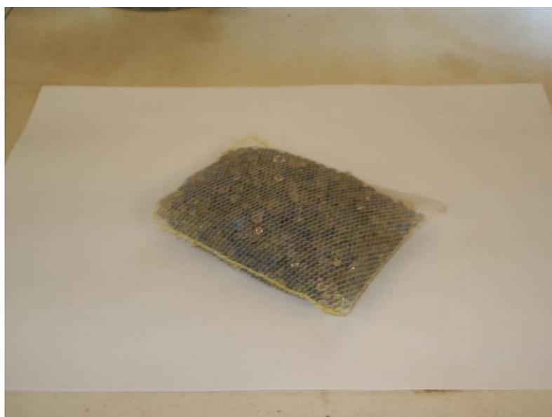
Figura 37: sílica gel colocada na câmara secadora para exposição a uma determinada UR gerada por solução salina saturada, colocada sob a base perfurada.
