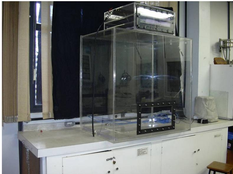
As caixas possuem ainda abertura para acesso interno, vedada com borracha comum e tampa fechada por borboletas com rosqueamento. As duas caixas são conectadas por uma mangueira de borracha com ¼" de diâmetro, fixada com bicos metálicos rosqueados às caixas de acrílico.
