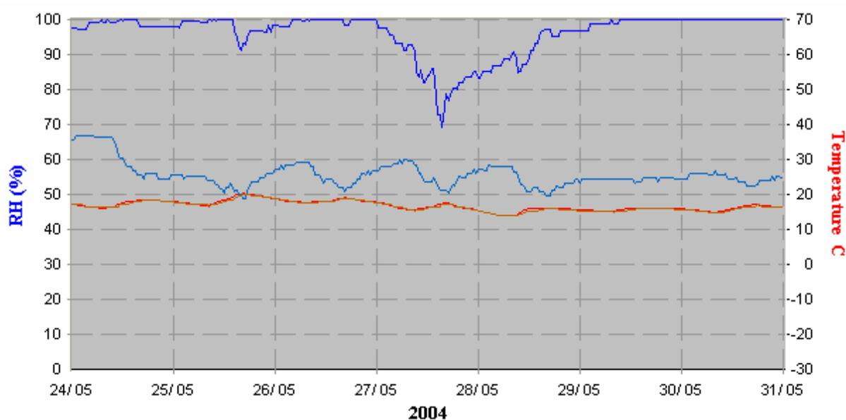
Na figura 48 podemos observar o comportamento higrométrico final do sistema, permanecendo com a média de 50% de UR até o final do procedimento experimental.
