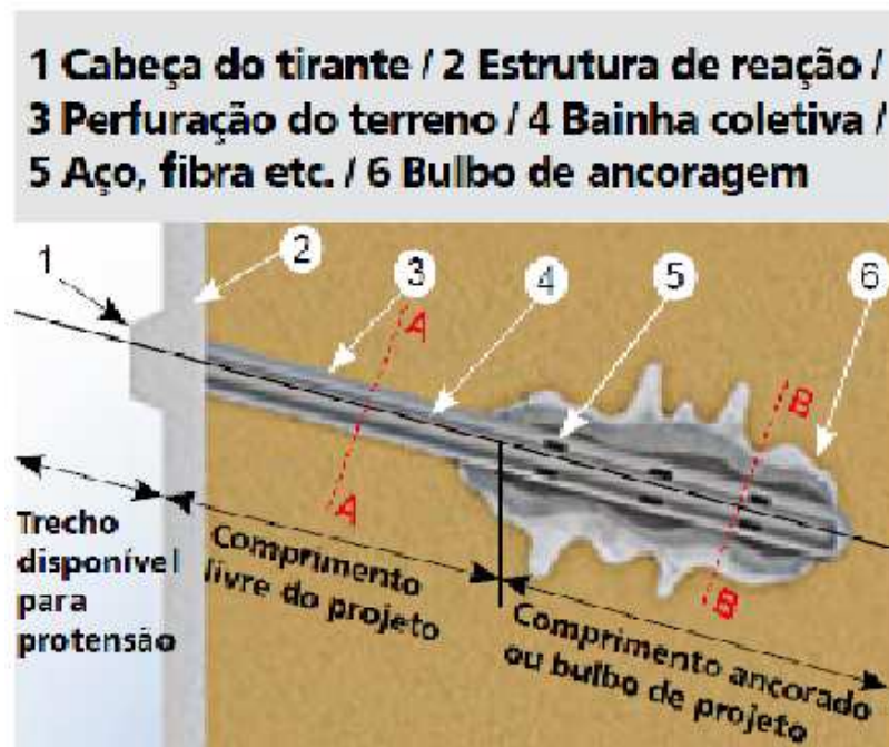
Figura 2.30: Partes construtivas do tirante
