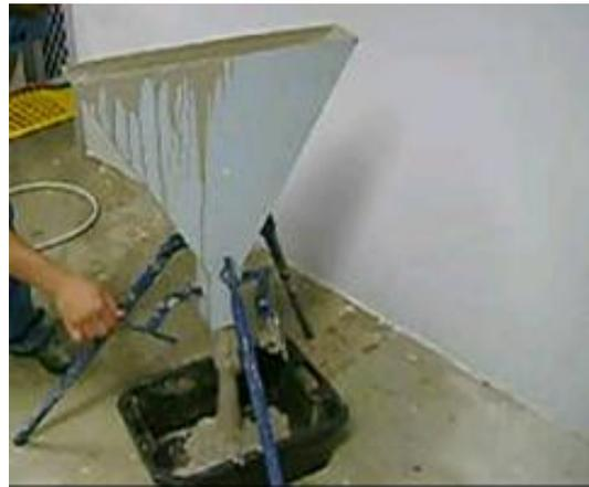
Figura 3: Equipamento e ensaio do funil V
