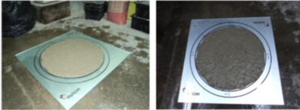
**Figura 2: Ensaio de viscosidade plástica aparente t500**
