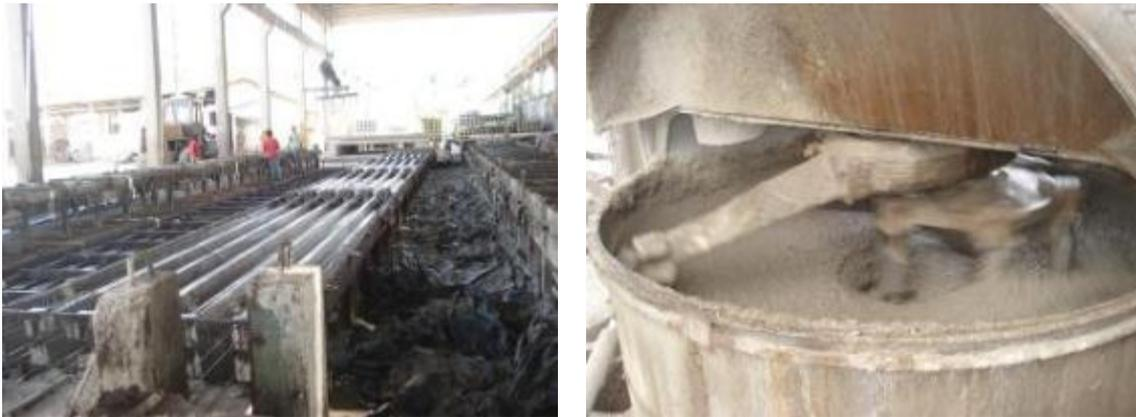
**Figura 11: Preparação das Formas e Mistura do Concreto**
