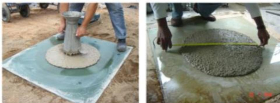
**Figura 1: Ensaio de espalhamento (Slump Flow)**
