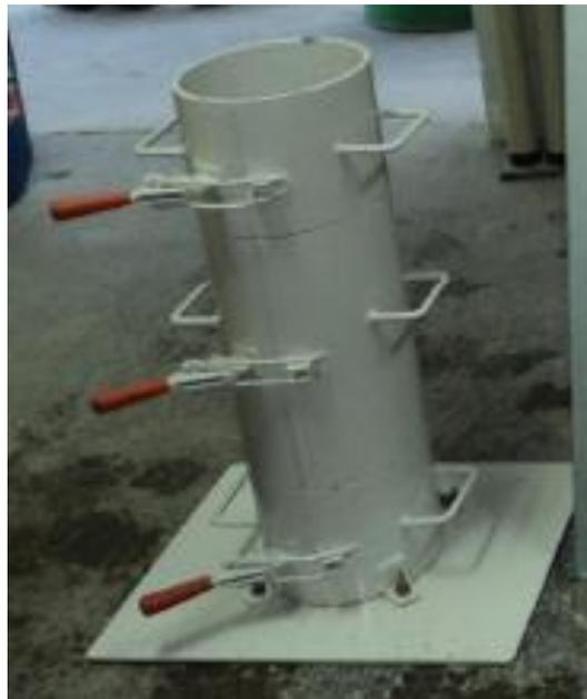
**Figura 6: Equipamento para ensaio de coluna de segregação**
