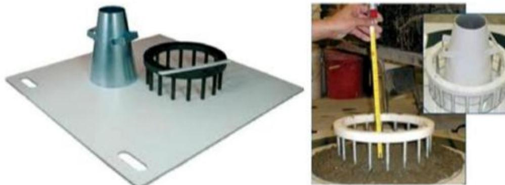
**Figura 5: Equipamentos e ensaio pelo anel J**
