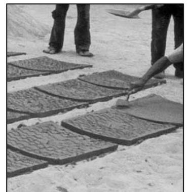
argamassa no meio da fôrma. Com uma colher de pedreiro, distribuir a massa por toda a fôrma e depois passar uma régua para acertar a massa por toda a fôrma e,
