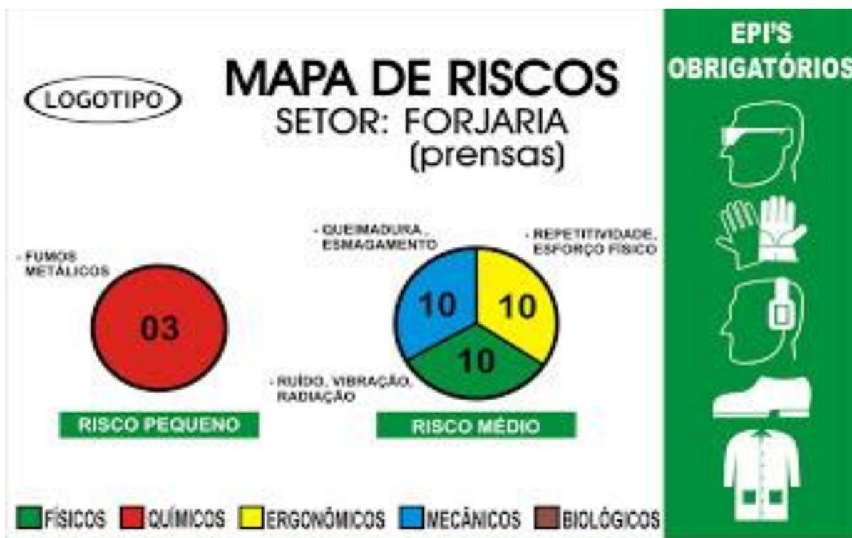
Figura 1 - Exemplo de um mapa de risco de uma instalação industrial.
