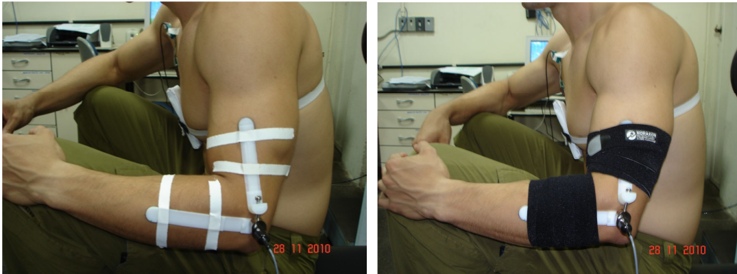
Figura 2 - Posicionamento e fixação do eletrogoniômetro.
