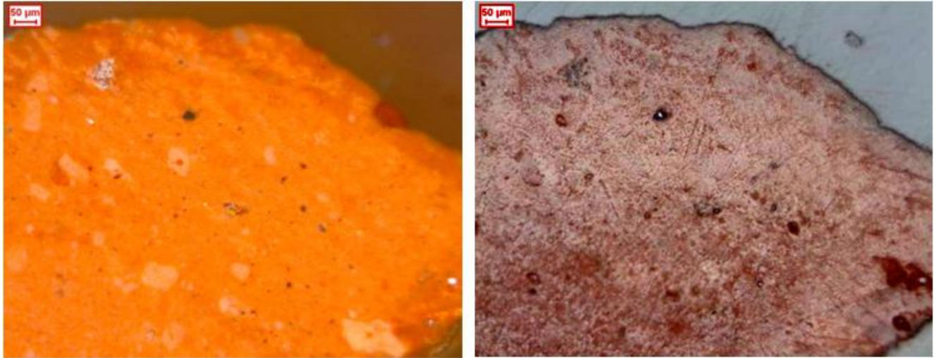
Figura 7.11 – Fotomicrografias – microscópio ótico de luz refletida – nicóis cruzados. Partículas contendo goethita terrosa.
