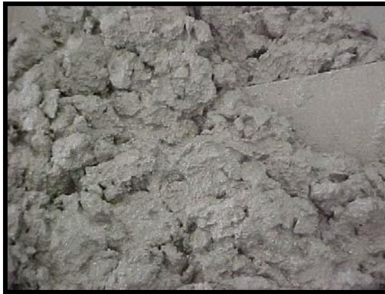
Figura 3.11 – Concreto composto por cimento, areia, brita e água. Fonte: Bastos, (2006).
