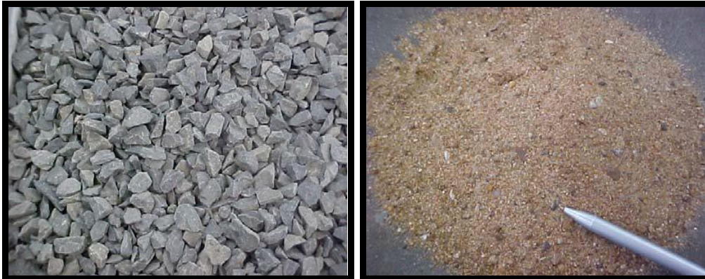
Figura 3.13 – Agregado graúdo (brita) e agregado miúdo (areia). Fonte: Fonseca, (2010).
