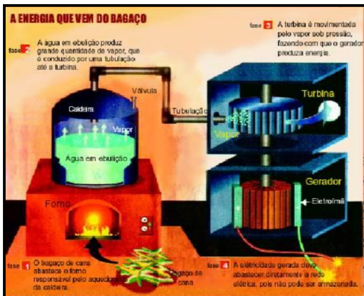
Figura 3.1 - Cogeração de energia produzida pela queima do bagaço da cana-de-açúcar. Fonte: www.açúcguarani.com.br , acesso em 19 dez. 2013.
