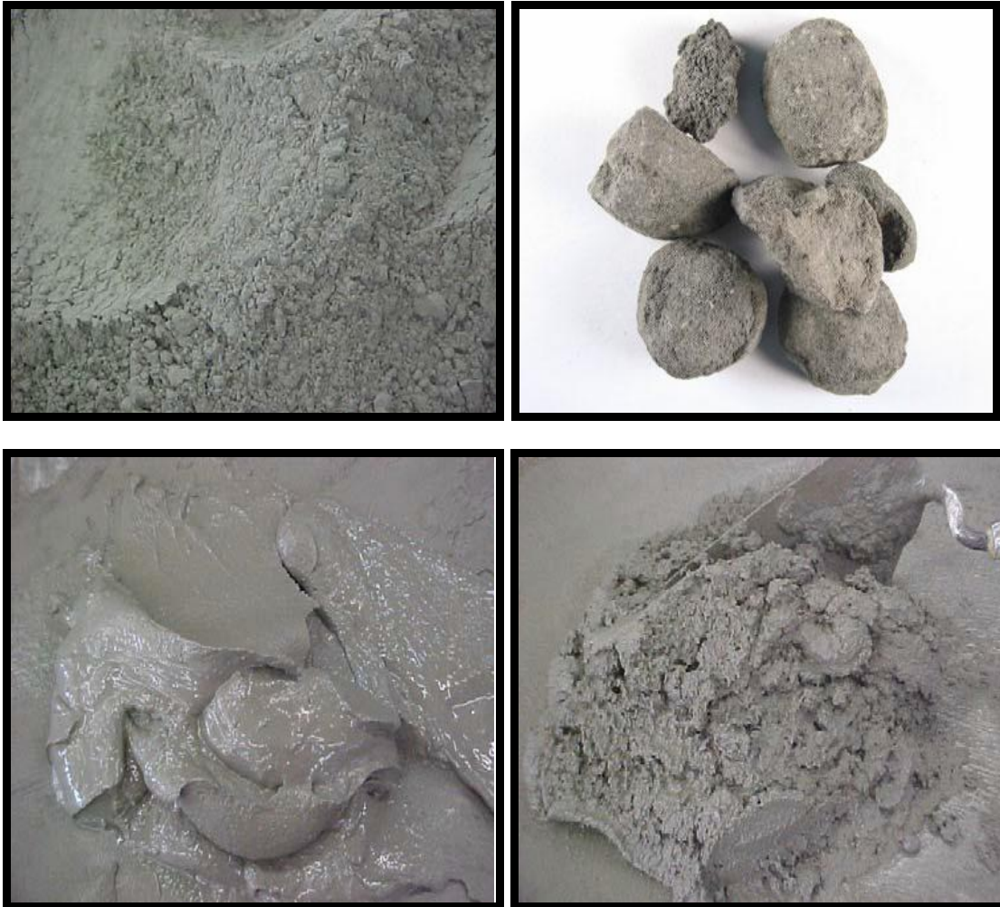
Figura 3.12 – Cimento; Clínquer; Pasta de cimento e água; e Argamassa de areia, cimento e água Fonte: Bastos, (2006).
