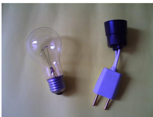
Figura 5 – Material utilizado para testar o funcionamento das tomadas
