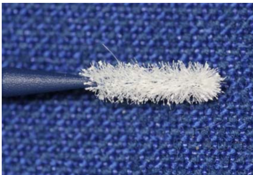
FIGURA 18 - Detalhe da ponta aplicadora onde está o agente iniciador da reação química Fonte: Pesquisa do autor/2006
