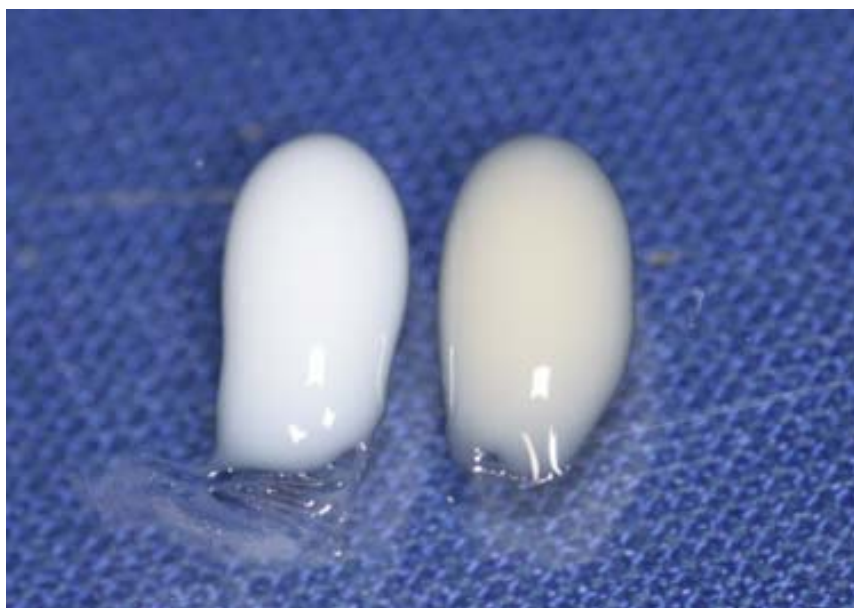
FIGURA 34 - Proporcionamento do cimento em placa de vidro Fonte: Pesquisa do autor/2006
