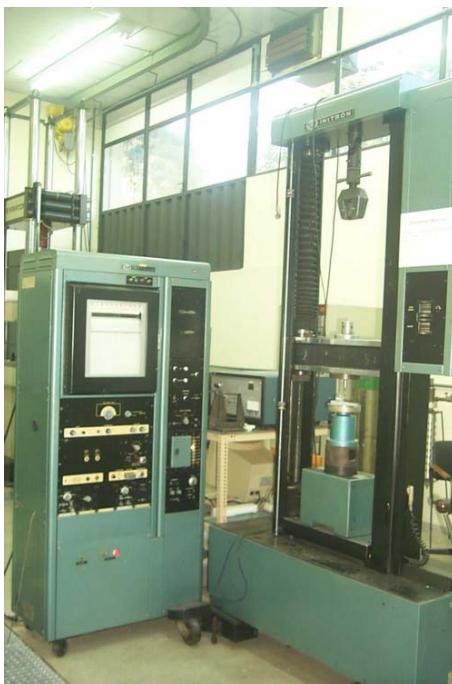
FIGURA 42 - Máquina de testes Universal Instron TTDML ® do CDTN/UFMG Fonte: Pesquisa do autor/2006
