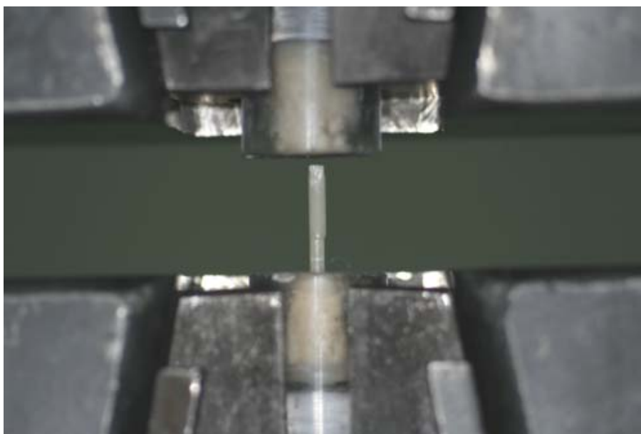
FIGURA 47 - Ensaio de tração em andamento Fonte: Pesquisa do autor/2006
