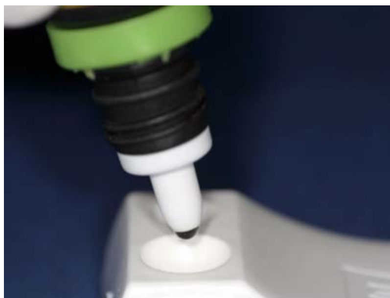
FIGURA 27 - Proporcionamento do catalisador Fonte: Pesquisa do autor/2006
