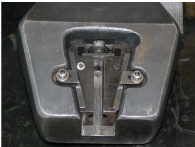
FIGURA 43 - Detalhe da garra para prensão dos corpos de prova Fonte: Pesquisa do autor/2006
