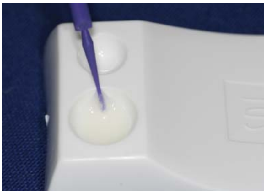
FIGURA 29 - Homogeneização de base e catalisador Fonte: Pesquisa do autor/2006
