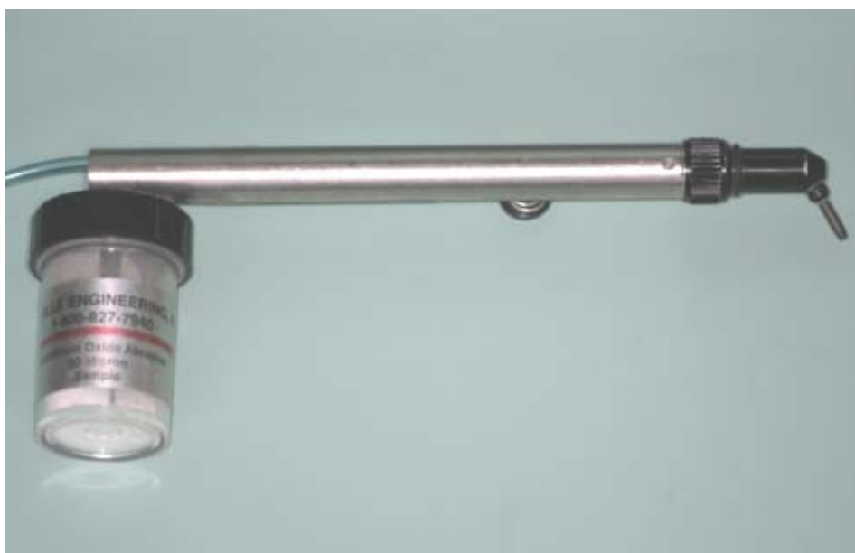
FIGURA 11 - Microjato Removedor de óxido de alumínio de 50µm Fonte: Pesquisa do autor, 2006
