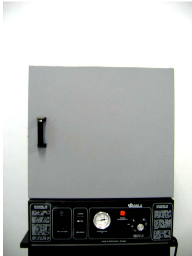
FIGURA 11 - Estufa Olidef® utilizada para a esterilização dos instrumentos ProFile e fios de NiTi.
