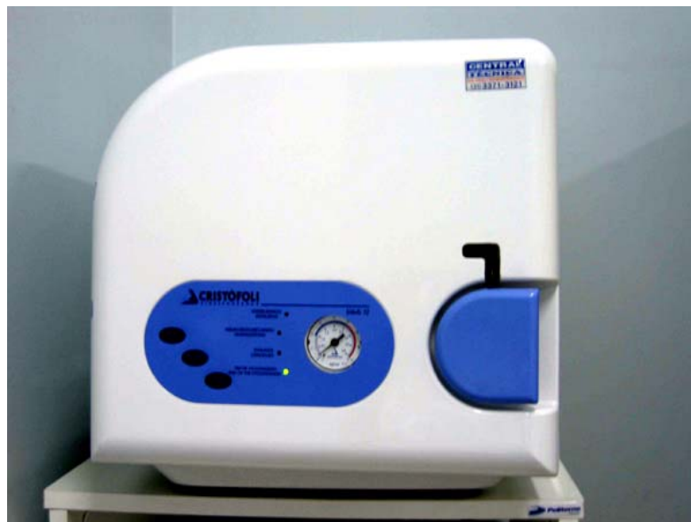
FIGURA 10 - Autoclave Cristófoli® utilizada para a esterilização dos instrumentos ProFile e fios de NiTi
