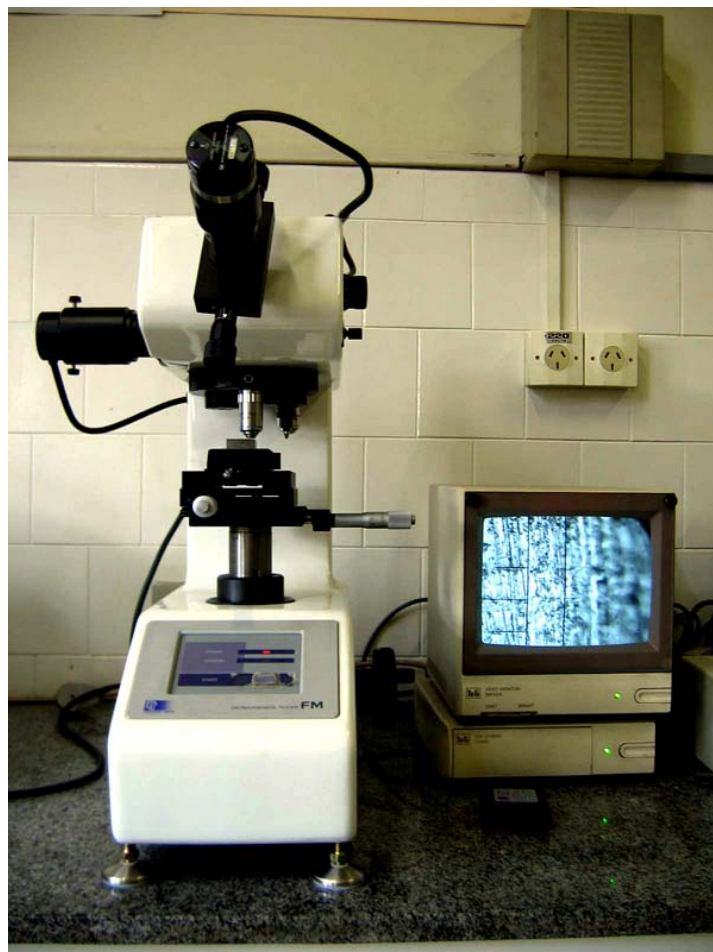
FIGURA 14 - Microdurômetro utilizado durante os ensaios de Microdureza Vickers
