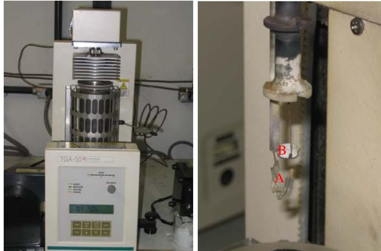
Figura 6 – Termobalança fechada e aberta, com detalhe no termopar (A) e cadinho de alumina (B).
