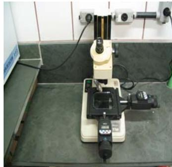
Figura 12- Microscópio comparador MITUTOYO
