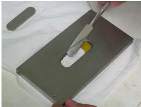
Figura 4- Material de Partida denso espalhado no Porta Amostras para HATR
