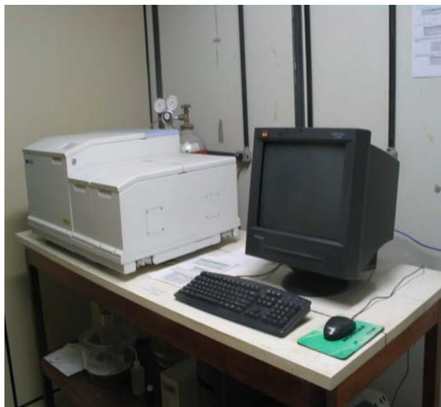
Figura 3- Espectrômetro de Absorção de Infravermelho
