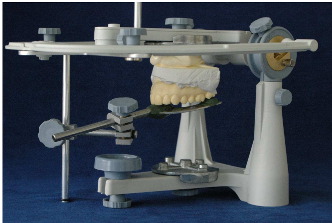
Figura 8 – Montagem do modelo superior com o arco facial devidamente posicionado no aparelho e fixação com gesso Tipo IV – Articulador Gnatus JP30®.
