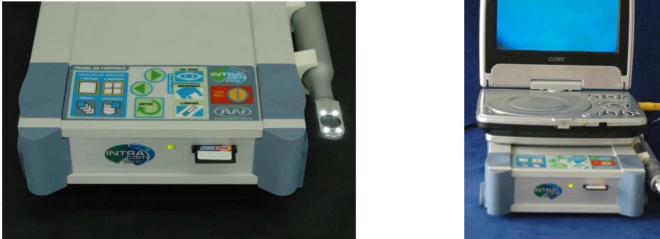
Figura 18 – A = Câmera intra-oral Intracam 2002, com cartão de memória de 64 MB; B = Câmera e monitor de 7 polegadas montados e prontos.
