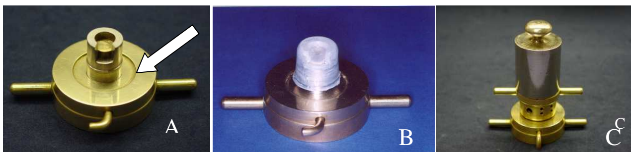
Figura 3 - Base de latão com sulco de adaptação da moldeira (A), alívio de silicone (B) e carga de 0,2Kgf aplicada (C).
