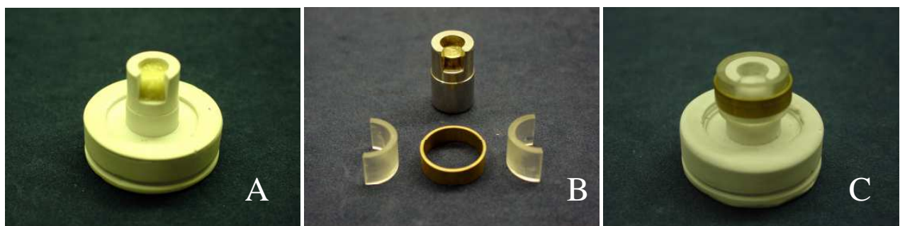
Figura 5 - Primeiro incremento aplicado (A), anel acrílico (B) e anel acrílico adaptado (C).
