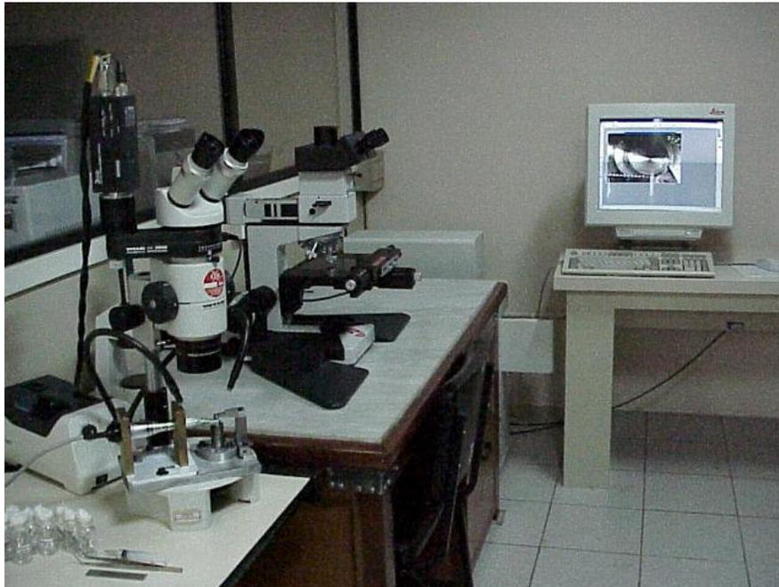
FIGURA 5.8 – Bancada de teste posicionada na lupa estereomicroscópica e a imagem do instrumento no canal artificial mostrada no monitor
