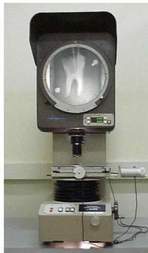
FIGURA 5.3 – Imagem radiográfica projetada no Projetor de Perfis com 10x de aumento
