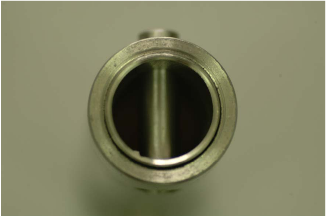
Fig. 25 – Tubo Metálico e Pinos para Padronização de Orientação dos Corpos-de-Prova. Vista de Topo
