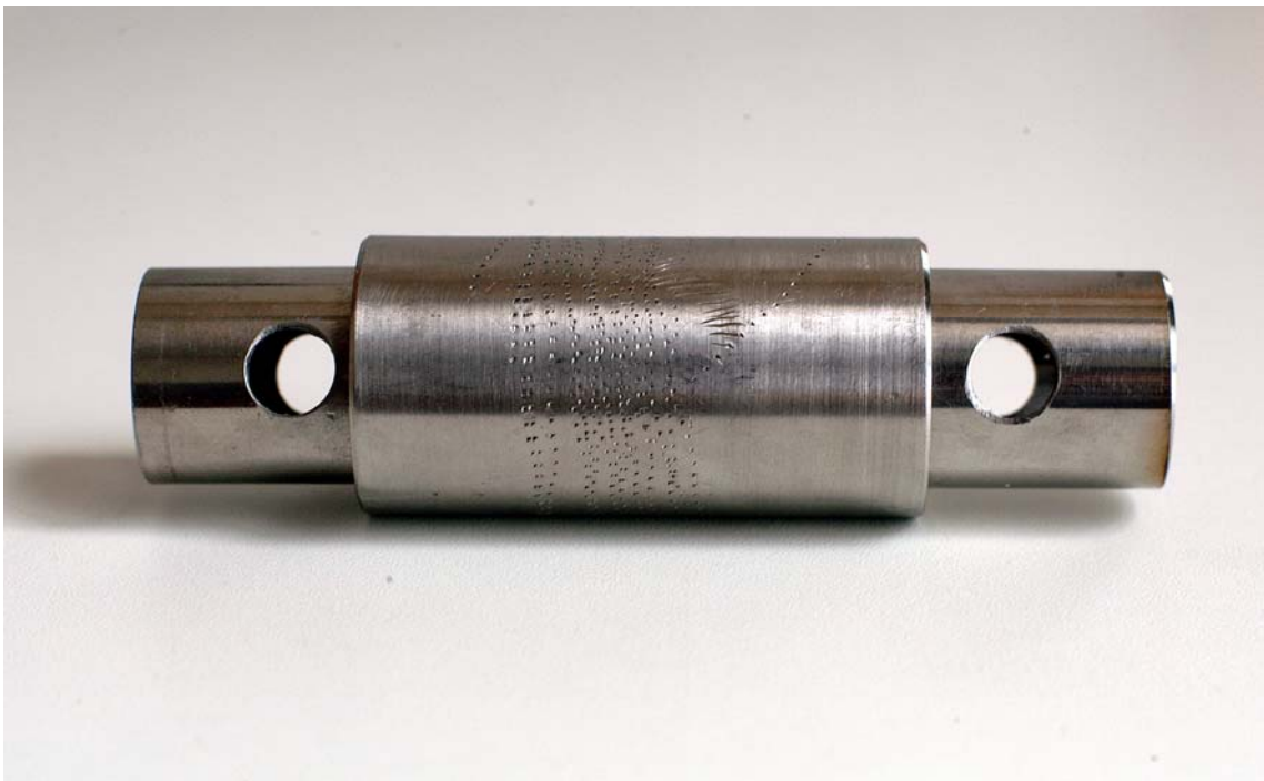
Fig. 28 – Tubo Metálico Limitador de Movimentos de Rotação Acoplado ao Corpo-de-Prova
