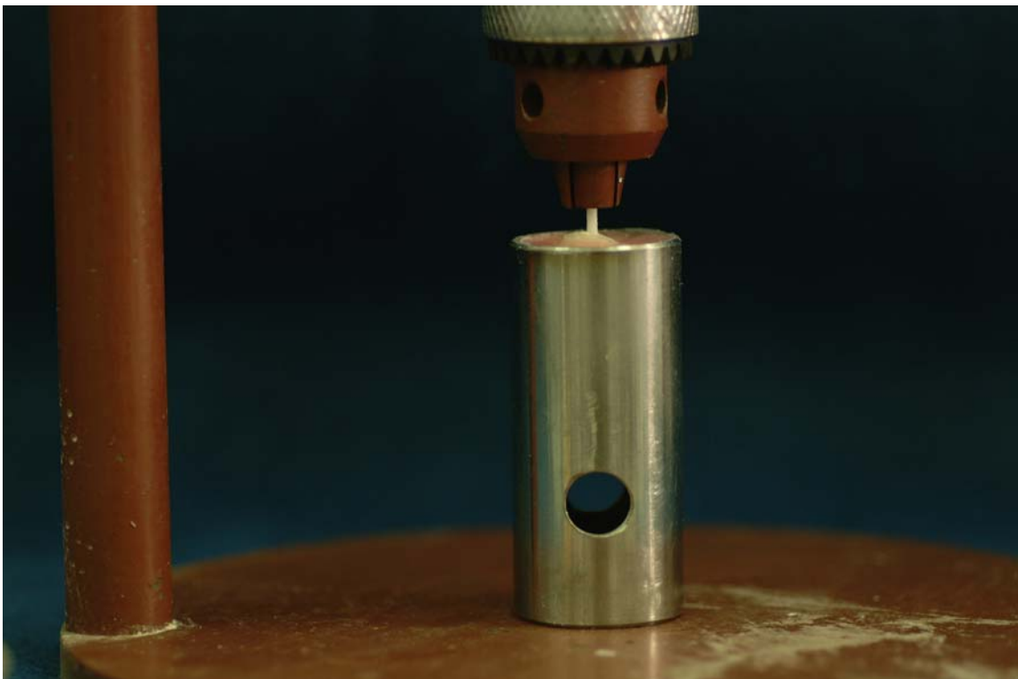
Fig. 19 – Inclusão da Raiz em Tubo Aço Inox com Resina Acrílica, com Auxílio de Paralelômetro
