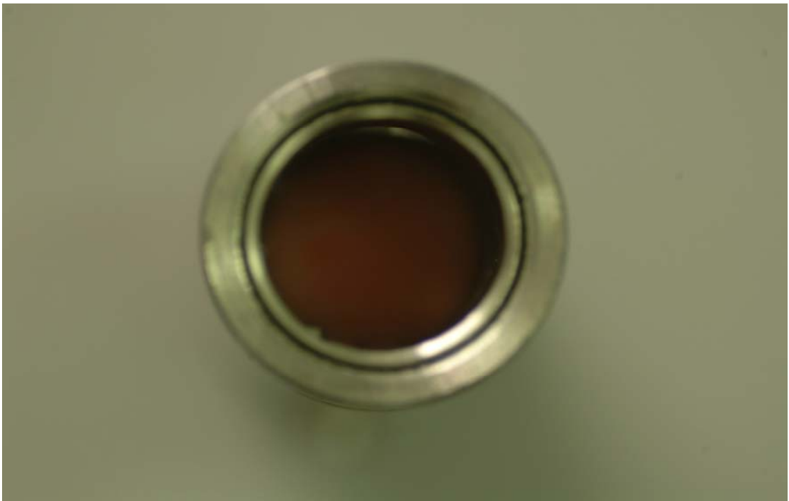
Fig. 23 – Tubo Metálico Guia para Padronização de Orientação dos Corpos-de-Prova. Vista de Topo
