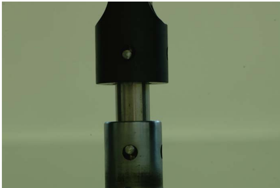
Fig. 27 – Corpo-de-Prova Adaptado à Máquina de Ensaio de Tração
