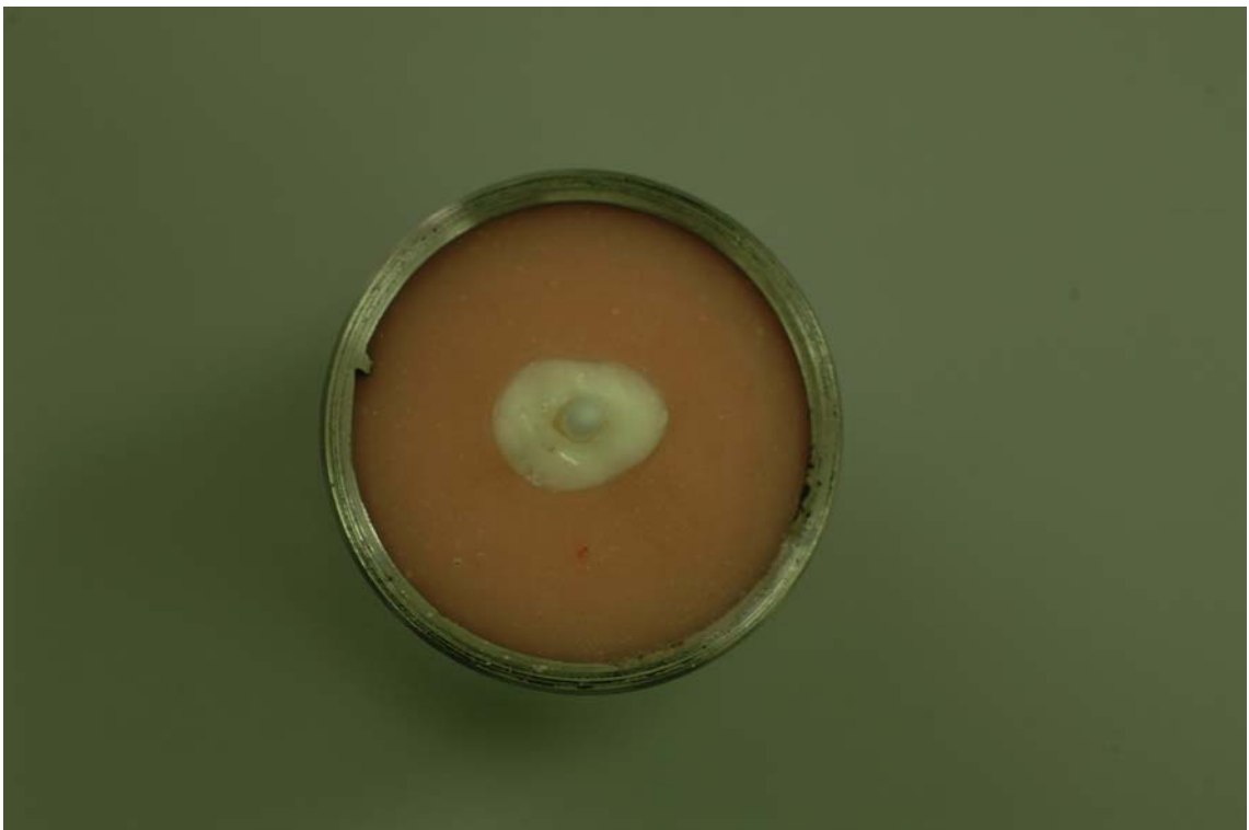
Fig. 21 – Conjunto Pino/Raiz Incluídos e Isolados em sua Superfície com Vaselina Sólida
