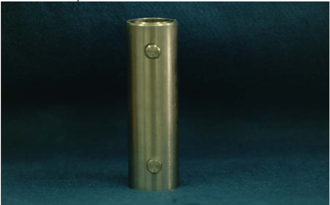
Fig. 24 – Tubo Metálico Guia e Pinos para Correta Orientação dos Corpos-de-Prova. Vista Lateral
