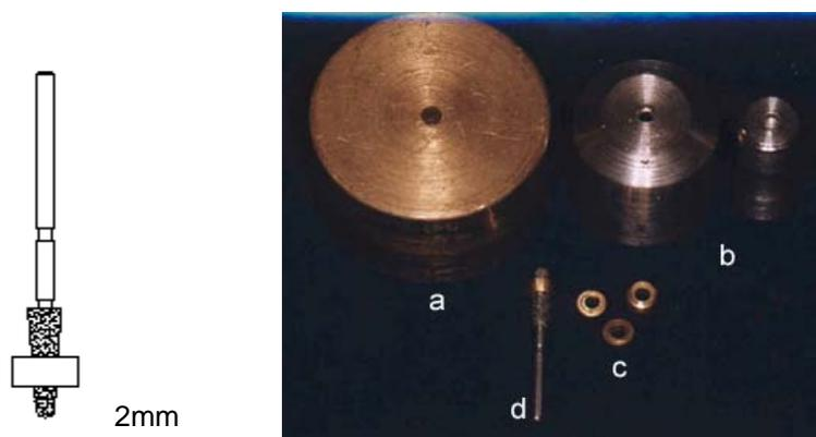
FIGURA 2 – no esquema da esquerda, é representado o cursor adaptado à ponta diamantada utilizada. Na fotografia estão evidenciados: a)dispositivo para remoção do cursor, b)dispositivos para inserir o cursor, c)cursores, d)cursor adaptado à ponta diamantada.
