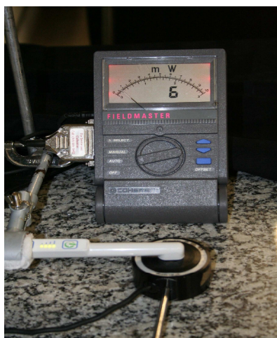
FIGURA 4 – Medidor de potência (FieldMASTER™ Coherent-USA); com aparelho Ultra-Lume™ LED 5 (ULTRADENT) encostado ao sensor, que era mantido fixo durante a medida.
