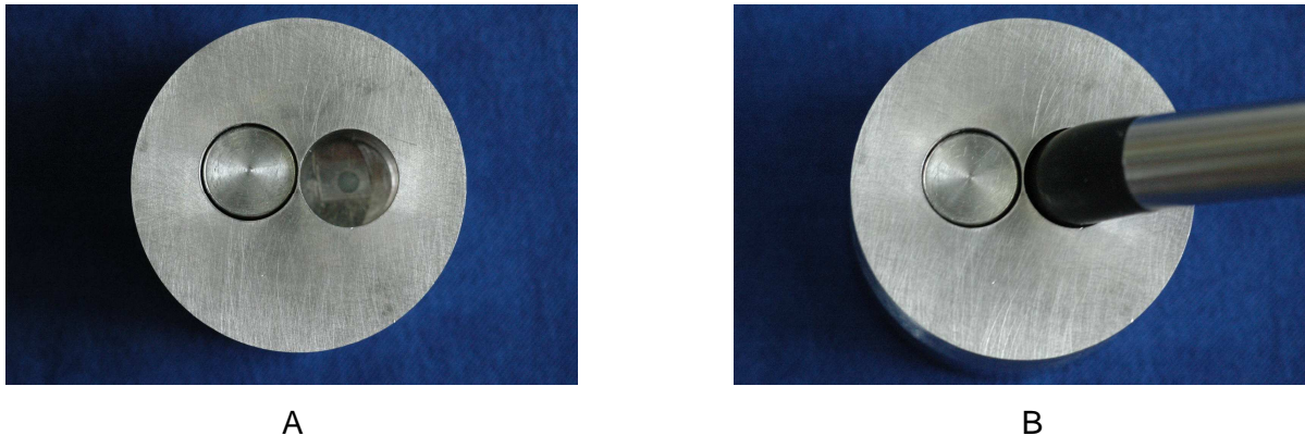
FIGURA 11 – (A) Pino guia atravessando a tampa, a matriz intermediária e a base, garantindo o correto alinhamento da parte central do orifício onde serão confeccionados os corpos de prova, (B) Ajuste da ponta da unidade de luz na tampa da matriz, objetivando o alinhamento da parte central da ponta óptica com o orifício da matriz, já centralizado.
