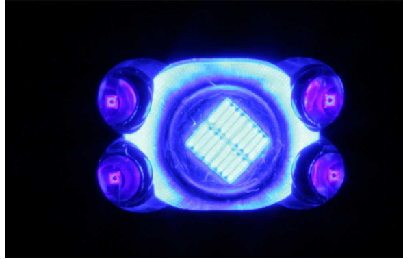
FIGURA 2 - Ultra-Lume™ LED 5 (ULTRADENT). Vista do LED central com espectro de luz com 450 a 490nm e cor azul e dos quatro LEDs periféricos com espectro de luz com 380 a 440nm e cor violeta/azul violeta.
