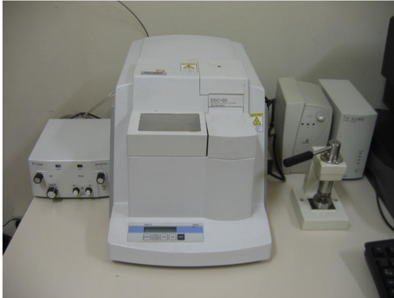
FIGURA 4.2- Differential Scanning Calorimetry (DSC) , utilizado na caracterização das temperaturas de transformação.
