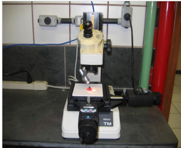
FIGURA 4.5 – Microscópio TM Mitutoyo (Japão) com instrumento posicionado para medida do ângulo de ponta.
