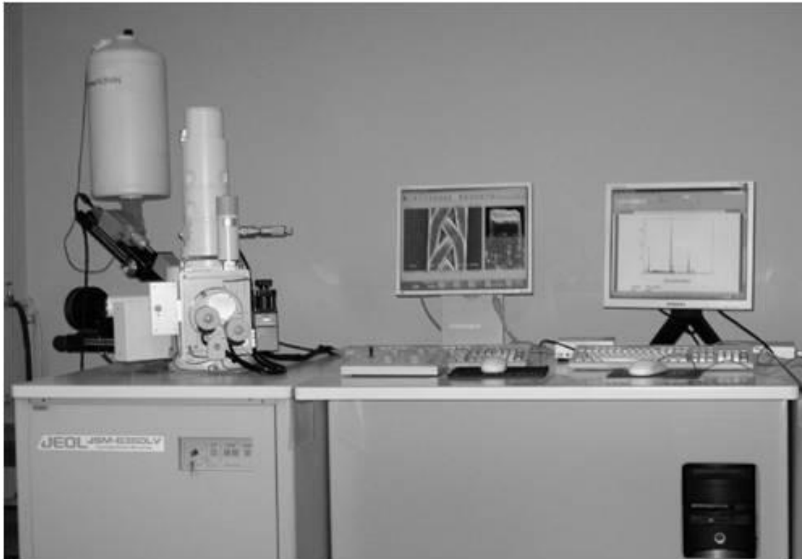
FIGURA 4.11 – Microscópio eletrônico de varredura – Laboratório de Microscopia e Microanálise da Escola de Engenharia da UFMG.
