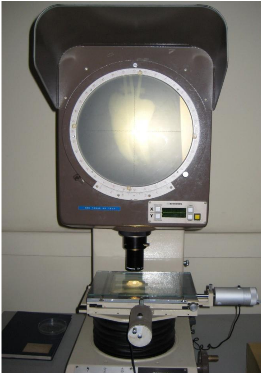
FIGURA 4.2 – Projetor de perfis para mensuração dos parâmetros geométricos: raio e ângulo de curvatura.
