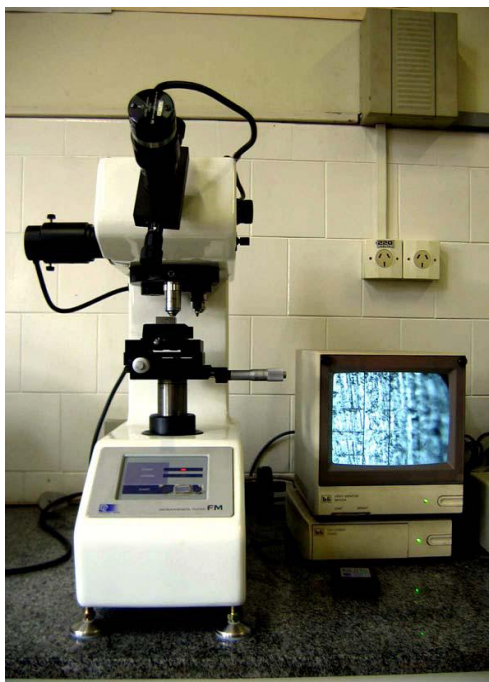
FIGURA 6 - Microdurômetro utilizado na realização dos ensaios de Microdureza Vickers
