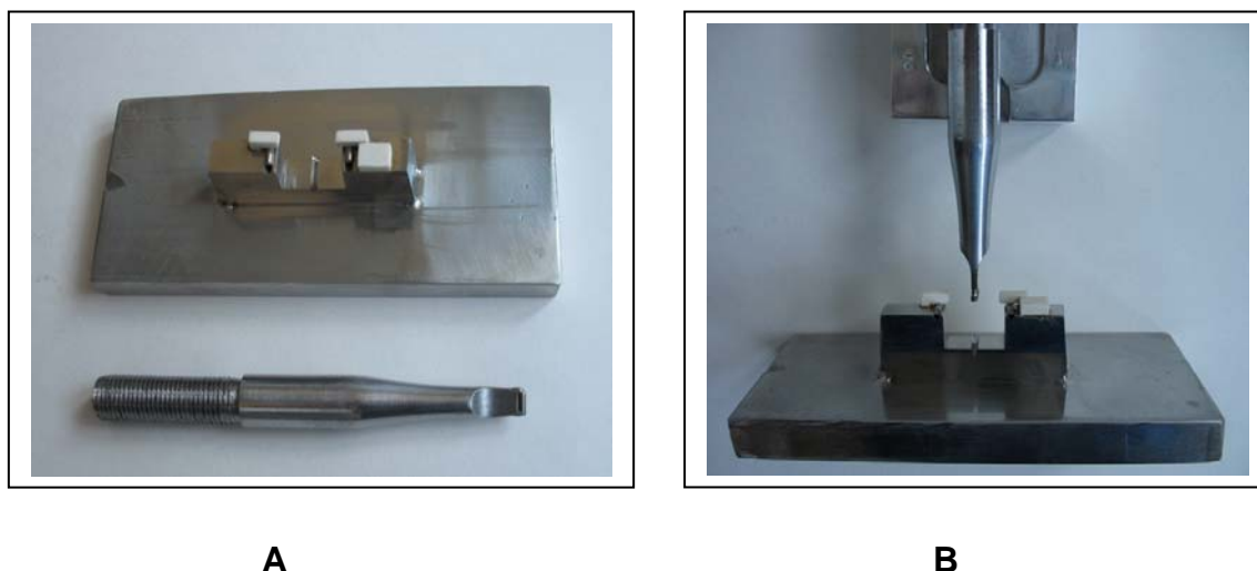
A= Base a ser fixada ao prato da máquina de ensaios mecânicos e dispositivo de aplicação de carga. B= Dispositivo de aplicação de carga em posição de teste
