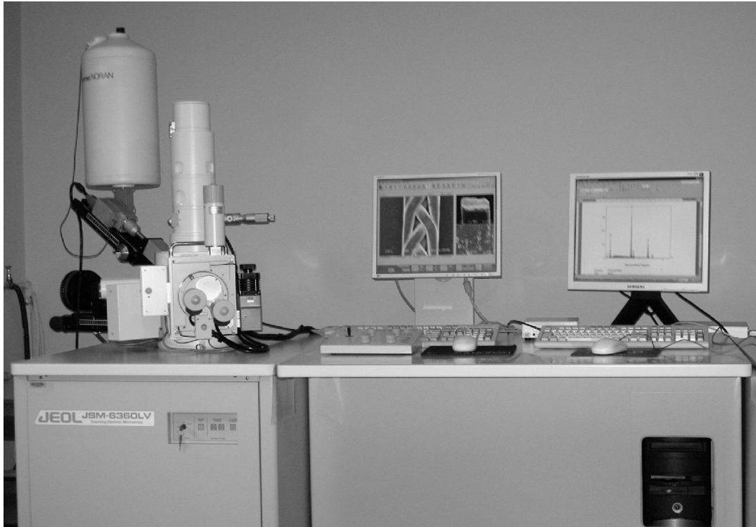
Figura 6: Microscópio eletrônico de varredura JSM 6360, utilizado para visualização do aspecto superficial dos instrumentos e das áreas das seções transversais.
