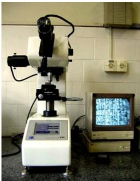
**FIGURA 12** - Microdurômetro utilizado na realização dos ensaios de Microdureza Vickers.
