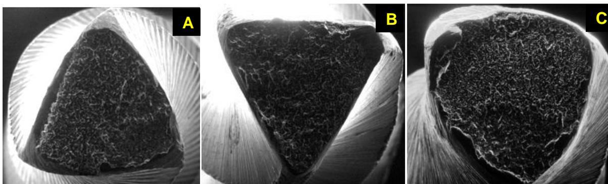
**FIGURA 41** – Superfície de fratura dos instrumentos Vortex (a), RaCe (b) e PTU (c).
