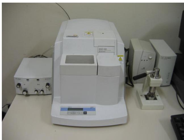
**FIGURA 10** - Equipamento DSC (*Differential Scanning Calorimetry*) utilizado para identificação das temperaturas de transformação de fase da liga.
