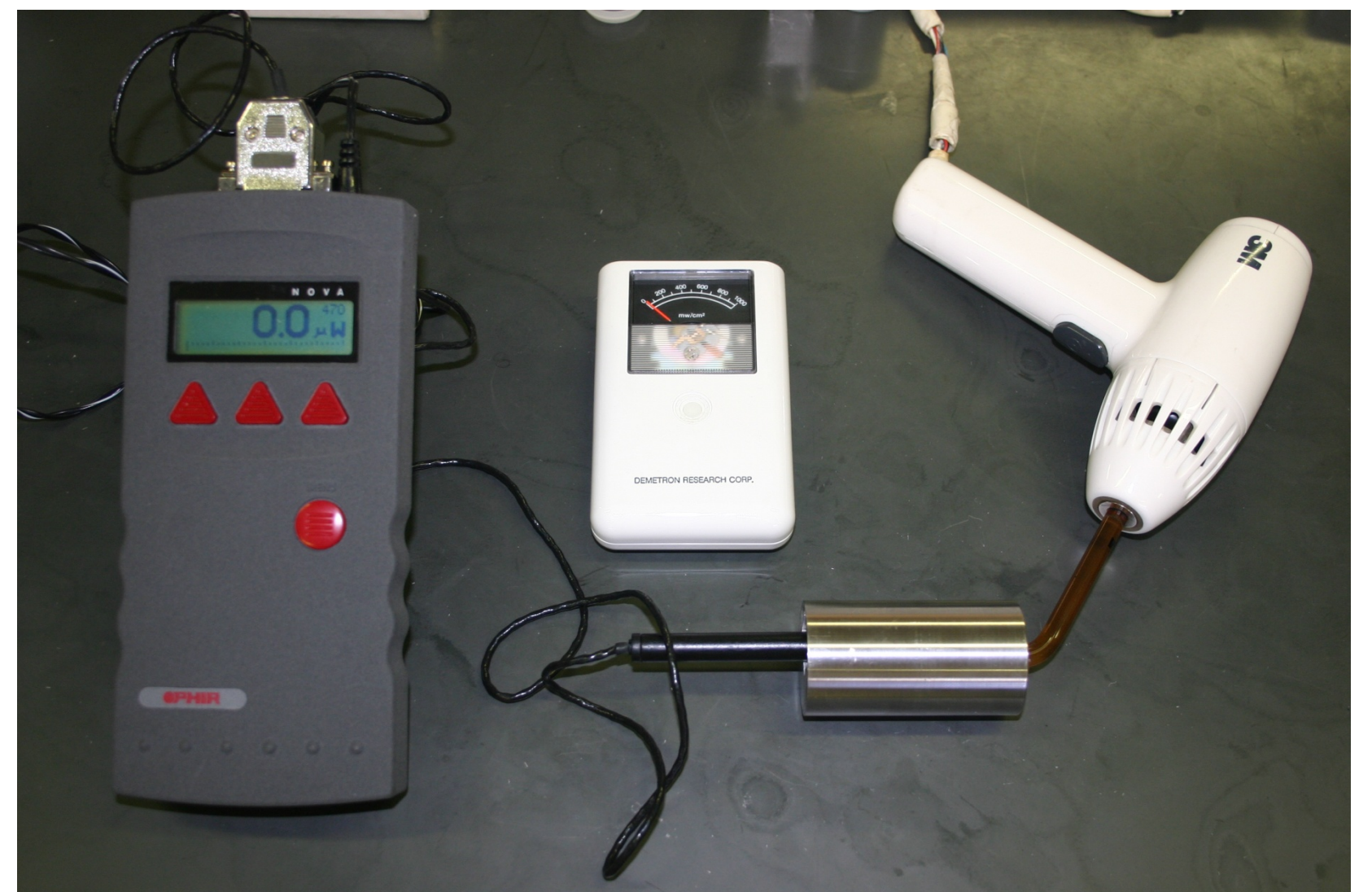
Fig. 20. Conjunto preparado para a avaliação: aparelho medidor de potência digital; radiômetro; matriz metálica e; aparelho fotopolimerizador.
