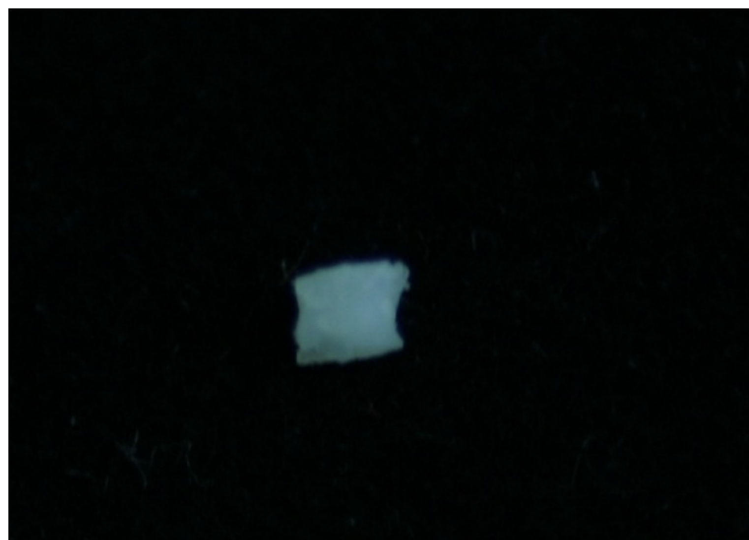
Fig. 26. Bloco de cimento resinoso após sua remoção da estrutura que contém o cimento (b). Três vezes de aumento.
