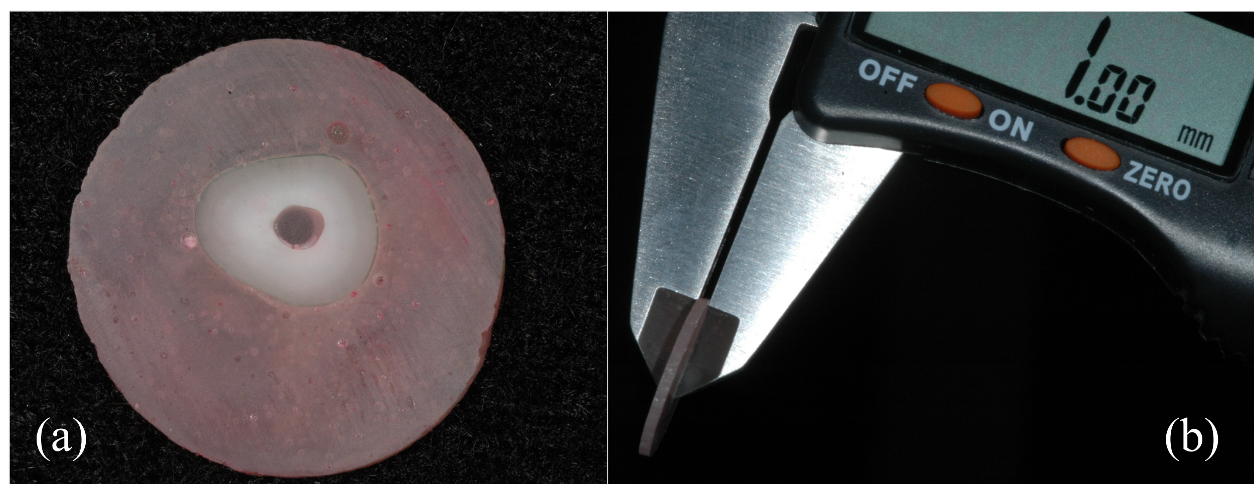
Fig. 6 (a) e (b). ... de modo a obter discos com 1 mm de altura.
