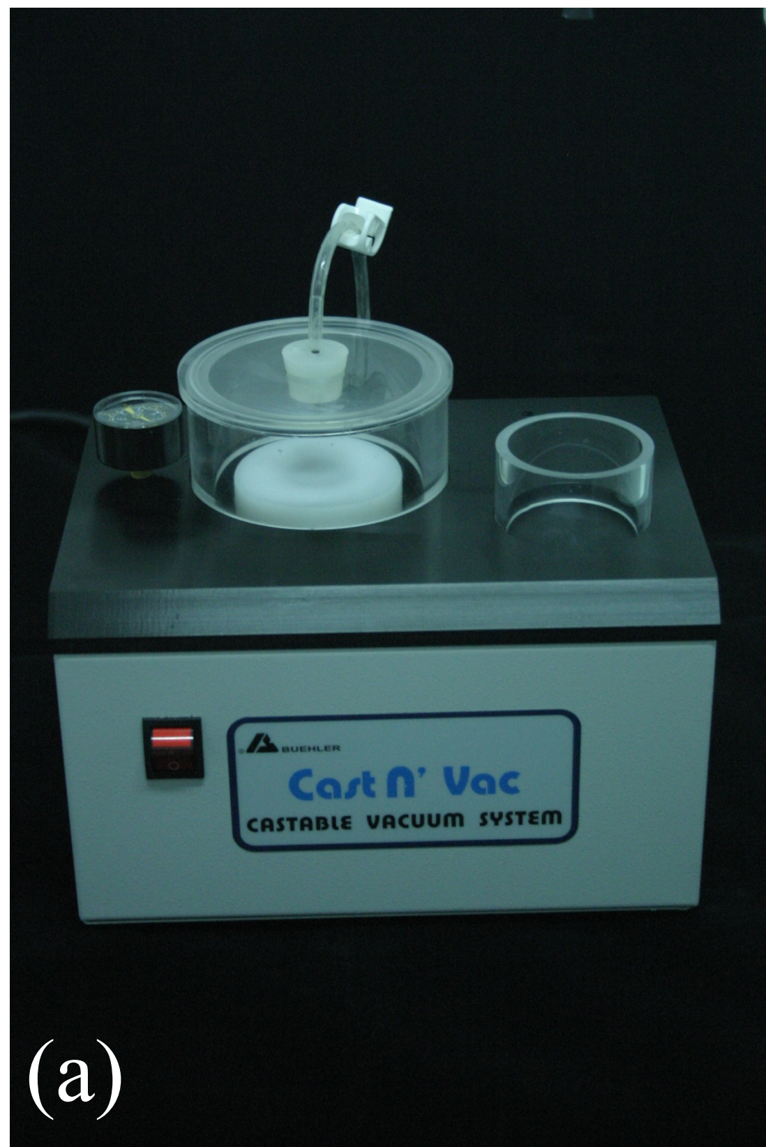
Fig. 31 a e b. Equipamento de inclusão a vácuo (Cast N'Vac, Buehler).
