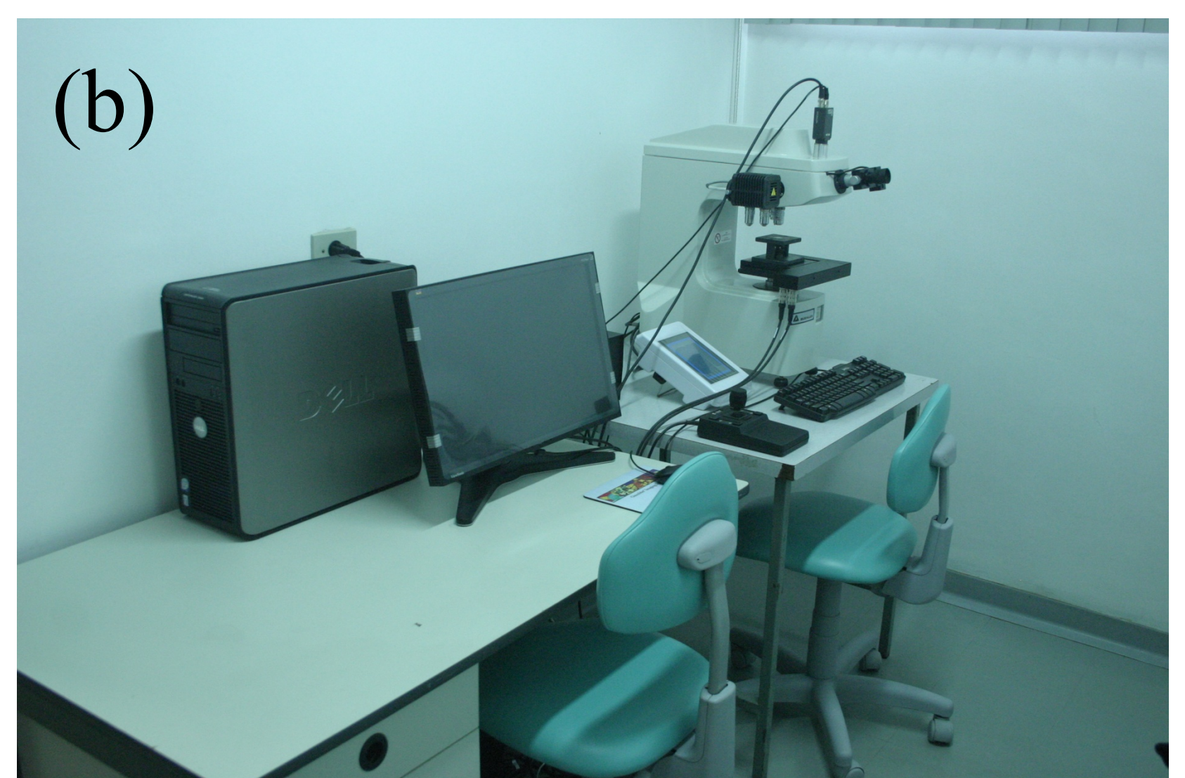
Fig. 33 a e b. Microdurômetro Micromet 5104 Buehler(a) e computador (b) para gerenciamento das imagens através do software Omnimet MHT.
