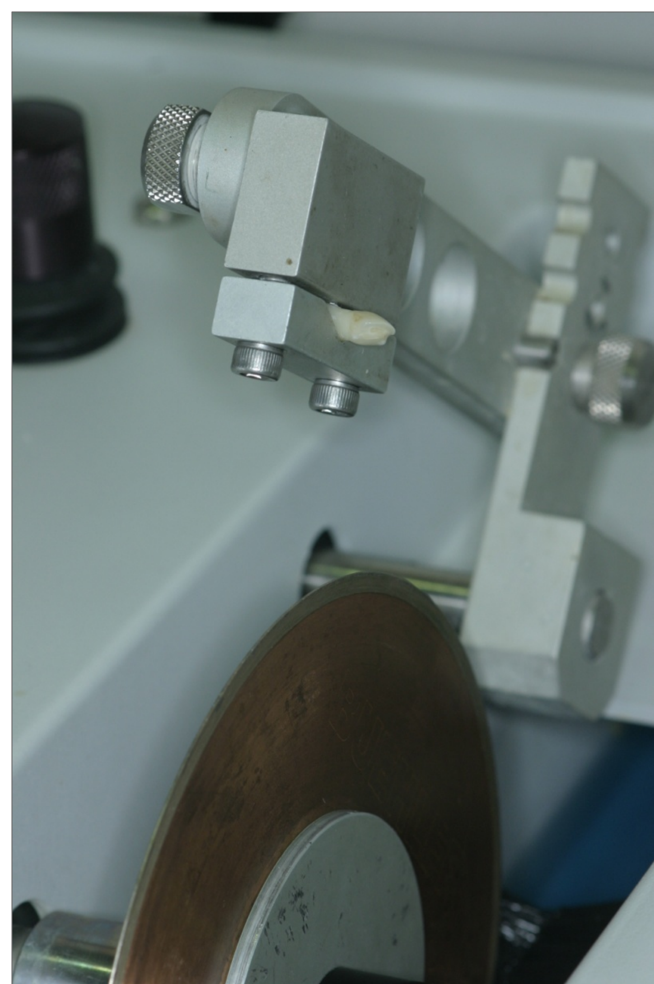
Fig. 4. Máquina de cortes precisos utilizada Isomet 1000 Buehler, para o corte das raízes e dos ...
