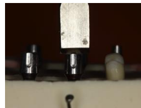
Figura 17 – Reprodução dos blocos e verificação do paralelismo entre os pilares
