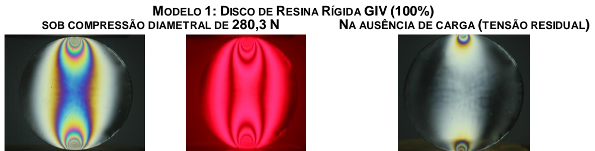
Figura 4 – Modelos sob compressão numa condição de luz branca, luz monocromática e na ausência de aplicação de carga (continua na próxima página)
